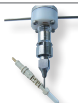
Dosierung eines 2-Komponenten Epoxys auf einen Glasfaserstecker
