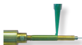
Dosierung von Fett auf Bohrköpfe für die maschinelle Fertigung
